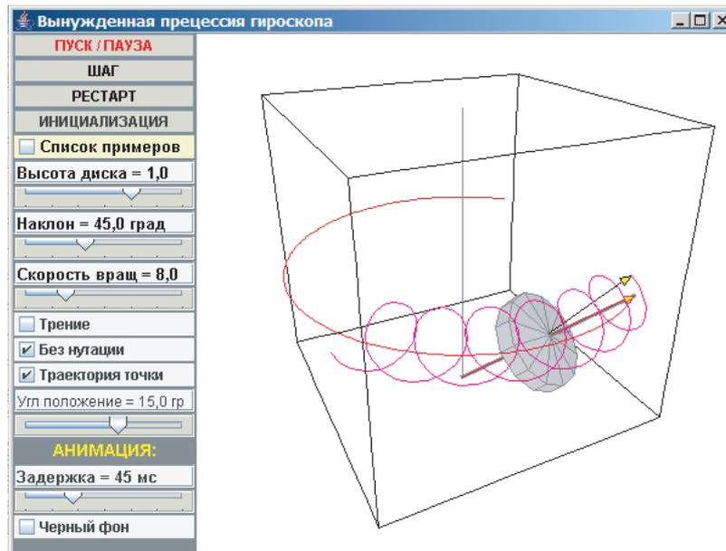
Рис. 2: Моделирование регулярной прецессии гироскопа. Показаны круговая траектория конца оси и петлеобразная траектория точки волчка, не лежащей на оси.
