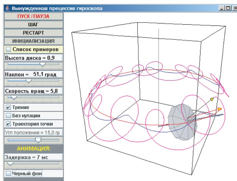
Рис. 7: Траектории оси волчка и точки, не лежащей на оси, при переходе псевдо-регулярной прецессии в установившуюся регулярную прецессию.
