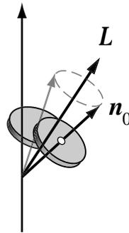
Рис. 4: Свободная прецессия (нутация) волчка вокруг направления полного момента импульса  $\vec{L}$  в отсутствие силы тяжести.
