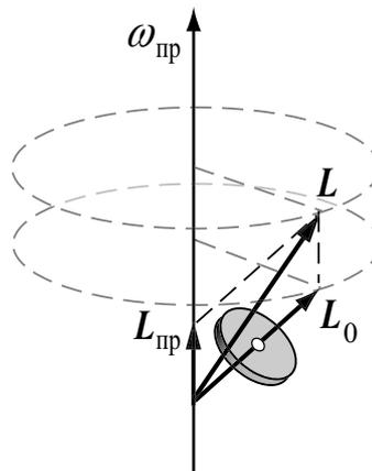
Рис. 3: Вектор  $\vec{L}$  момента импульса волчка при регулярной прецессии.
