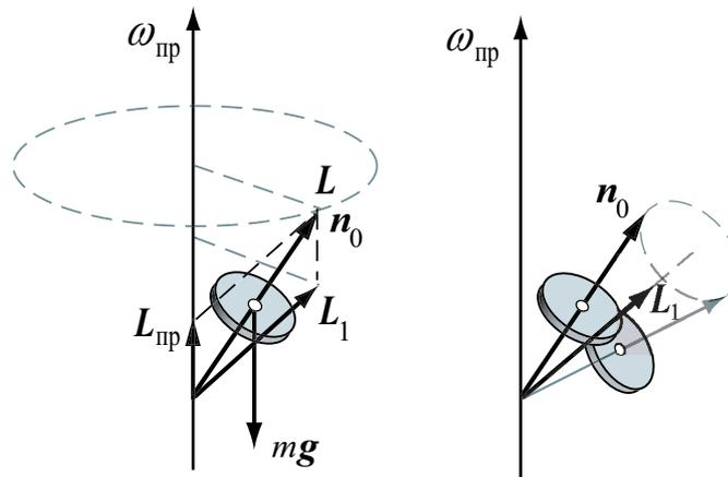
Рис. 5: Наложение нутации оси волчка вокруг направления вектора  $\vec{L}_1$  на вынужденную прецессию.
