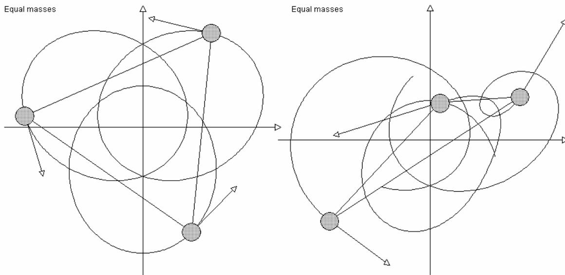
Рис. 3. Эллиптические траектории трех одинаковых тел в равносторонней конфигурации (слева) и неустойчивость таких движений, развивающаяся при малом нарушении симметрии системы.
