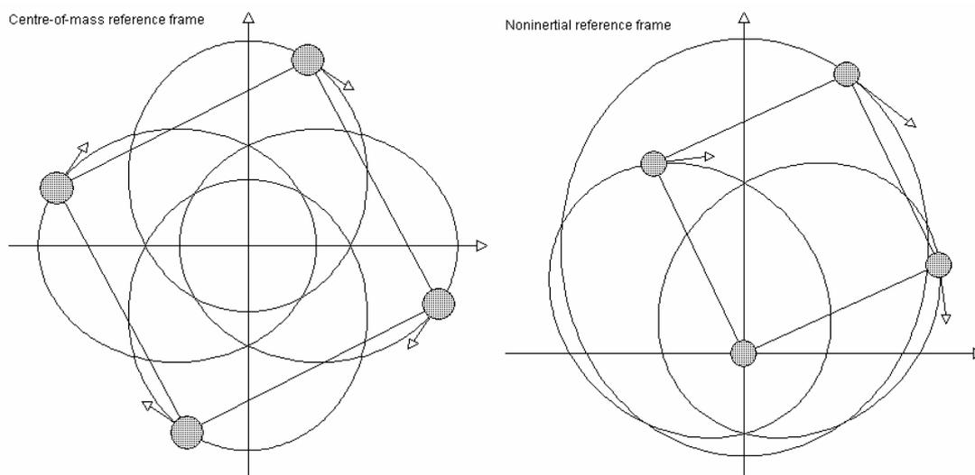
Рис. 6. Кеплеровы движения четырех одинаковых тел в симметричной равносторонней конфигурации. Слева показаны орбиты тел в системе центра масс, справа – в системе отсчета одного из тел.
