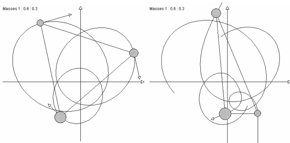
Рис. 5. Эллиптические движения трех тел разных масс в равносторонней конфигурации (слева) и иллюстрация неустойчивости таких движений (справа).
