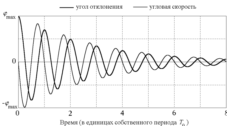
Рисунок 2. Графики затухающих колебаний осциллятора, происходящих после начального возбуждения отклонением из положения равновесия.
