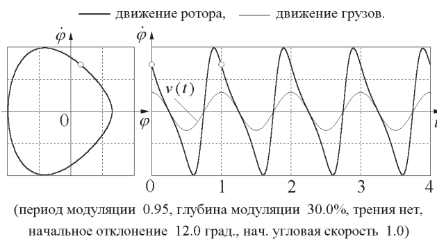
Рис. 8. Фазовая траектория и график угловой скорости стационарных колебаний на границе интервала параметрического резонанса второго порядка ( n = 2 )
