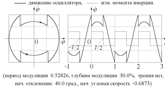
Рис. 6: Стационарные параметрические колебания на верхней границе основного интервала неустойчивости (вблизи T = T_{av}/2 ).
